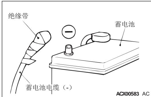
从蓄电池上断开蓄电池负极电缆，并用胶带封住端子，以防止意外连接和安全气囊膨开。
